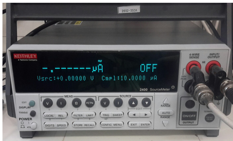
Figura 5.2: Keithley 2400 Source Meter utilizzato per effettuare le misure elettriche. Nelle boccole sono inseriti gli adattatori BNC
